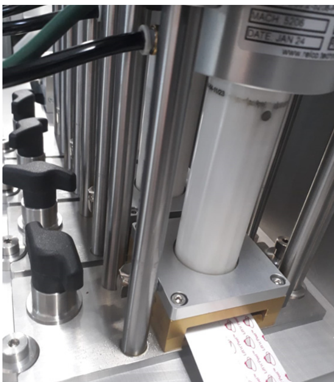
Detail prostřihovací a navařovací keramické hlavy
